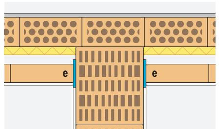
En el caso de paredes simples (Silensis tipo 1) el encuentro de las hojas interiores de la fachada y la pared separadora se realizará con bandas elásticas (e) salvo en el caso de que las hojas interiores presenten una masa  $m > 120 \text{ Kg/m}^2$  y  $R_A > 42 \text{ dBA}$  y con determinadas combinaciones de elementos constructivos.
