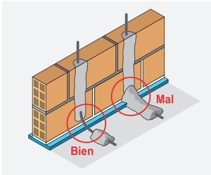
Para evitar transmisiones en las paredes dobles (Silensis tipo 2A ó 2B), se evitará en todo momento la unión rígida de las hojas de la pared separadora que llevan bandas elásticas con los forjados superior e inferior, ocasionada por el macizado de mortero que cubre las instalaciones.
