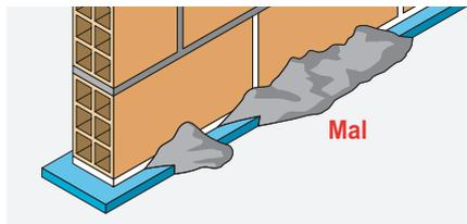
En los tabiques, hojas interiores de fachada y paredes separadoras con bandas en la base, hay que limpiar las rebabas y restos de pasta que hayan caído conectando la banda con el forjado, pues podrían suponer puntos de conexión rígida de la pared con el forjado.
