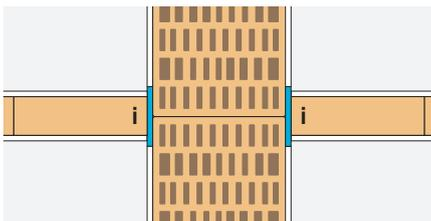
En el caso de paredes simples (Silensis tipo 1) el encuentro de los tabiques y la pared separadora se realizará con bandas elásticas (i) salvo en el caso de que las hojas interiores presenten una masa  $m > 120 \text{ Kg/m}^2$  y  $R_A > 42 \text{ dBA}$  y con determinadas combinaciones de elementos constructivos.
