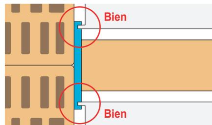
1º Una vez aplicado el yeso a la pared y al tabique, apoyando la llana en el tabique u hoja interior de fachada, cortar verticalmente el yeso hasta alcanzar la banda elástica.
