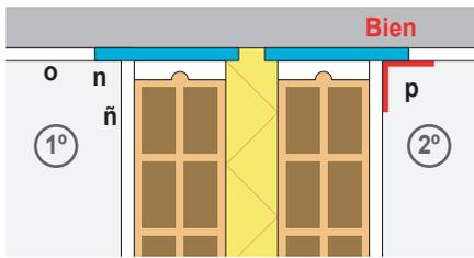
1º Se deja descubierta la banda elástica (n), aplicando el yeso de la pared contra la banda elástica (ñ) y el yeso del techo contra la banda elástica (o).
