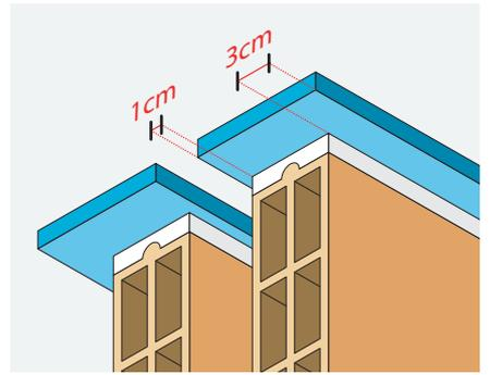
La banda de la cima se pegará al forjado superior de forma que sobresalga 3 cm hacia el exterior del tabique y 1 cm hacia el interior de la cámara. El retacado de yeso se realizará contra la banda elástica, evitando en todo momento que el yeso contacte con el forjado superior. Una vez realizado el retacado, se eliminarán los posibles restos de yeso que cubran la banda hasta dejarla visible.
