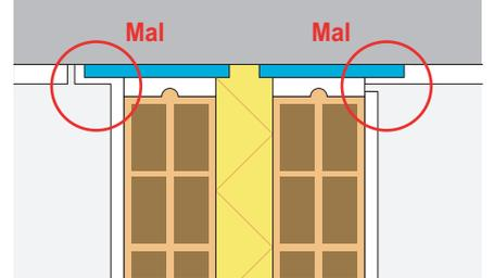
1º) Una vez aplicado el yeso a la pared y al techo, pegando la llana contra la pared, cortar verticalmente el yeso hasta alcanzar la banda elástica.
