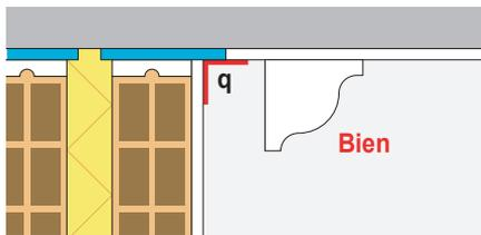
En las hojas con bandas elásticas de las paredes separadoras de 2 hojas (Silensis tipo 2A ó 2B) caso de colocar moldura, ésta debe colocarse pegada sólo al techo o a la pared. Antes de colocar la moldura es necesario colocar la banda de papel (q).
