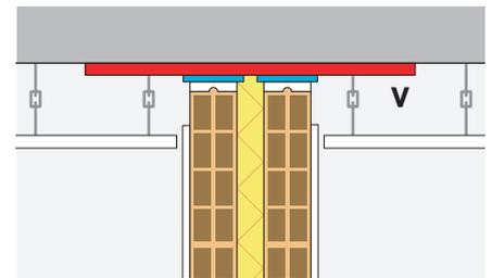
Si el forjado es de bovedillas o casetones debe colocarse un elemento sellante (v) para evitar transmisiones a través del forjado. Si las viguetas son paralelas a la pared separadora, el material sellante se aplicará de vigueta a vigueta. Si son perpendiculares a la pared separadora, el material sellante se aplicará de bovedilla a bovedilla.
