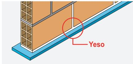
La primera hilada de los tabiques de ladrillo de pequeño formato recibidos con mortero de cemento, pegamento-escayola o cualquier otro material de agarre que garantice una buena adherencia del ladrillo a la banda.
