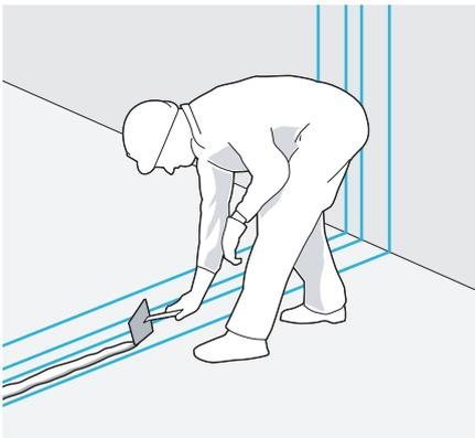
Las bandas elásticas se adhieren a los forjados, pilares y fachadas, con yeso, pegamento-escayola o cualquier otro material de agarre que garantice una buena adherencia de la banda a dichos elementos.
