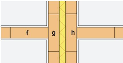
Los tabiques interiores (f) se interrumpen al acometer a la pared separadora (g). En el caso de paredes dobles (Silensis tipo 2A o 2B) el encuentro de los tabiques interiores y la pared separadora se realizará mediante traba o a testa (h).
