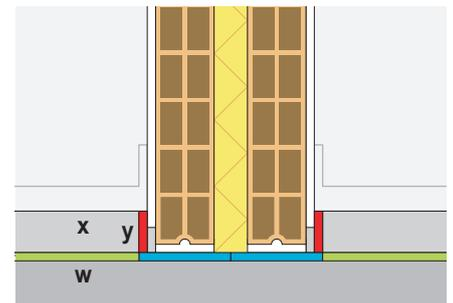
Se evitará dejar discontinuidades en la colocación de la lámina anti-impacto (w) a través de las cuales la niveladora de mortero (x) pueda entrar en contacto con el forjado inferior. Para ello se emplearán bandas perimetrales, cintas de solapes o plásticos (y) siguiendo las recomendaciones del fabricante de la lámina anti-impacto.
