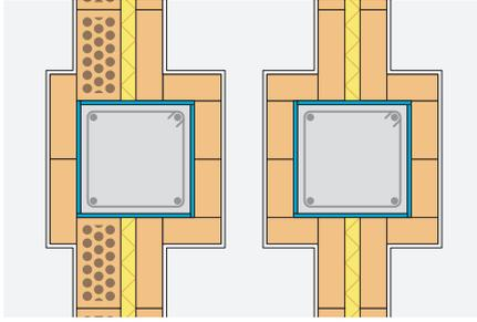
En el caso de paredes separadoras de 1 hoja el encuentro se hace de forma tradicional. En el caso de paredes separadoras de 2 hojas, la/s hoja/s (1 ó 2) de la pared separadora en contacto con pilares, llevará/n bandas elásticas en su unión con el pilar.
