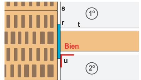
1º Se deja descubierta la banda elástica (r), aplicando el yeso de la pared contra la banda elástica (s) y el yeso del tabique u hoja interior de la fachada contra la banda elástica (t).
