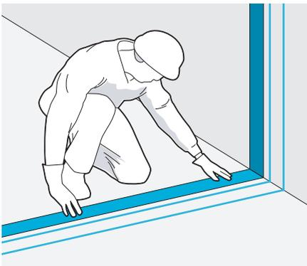
En el caso de paredes separadoras con bandas elásticas perimetrales, antes de levantar la fábrica deben colocarse las bandas elásticas:
