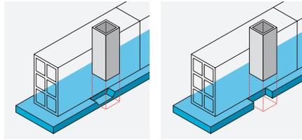
Se realizará aplastando la banda elástica o realizando un mínimo cajeado. Se evitará en todo momento el contacto del ladrillo con el forjado.
