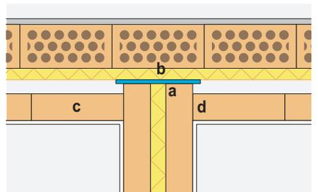
La pared separadora (a) se lleva contra la hoja exterior de la fachada (b). Las hojas interiores de la fachada (c) se interrumpen en su encuentro con la pared separadora. En el caso de paredes dobles (Silensis tipo 2A ó 2B) el encuentro de las hojas interiores de la fachada y la pared separadora se realizará mediante traba o a testa (d).
