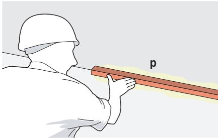
2º Se remata colocando una tira de papel para tapar la junta (p) empleando pasta de juntas sin cubrir la banda.
