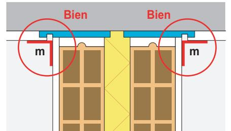
2º) Rematar colocando una tira de papel (m) para tapar la junta, empleando pasta de juntas que no debe penetrar en el corte.
