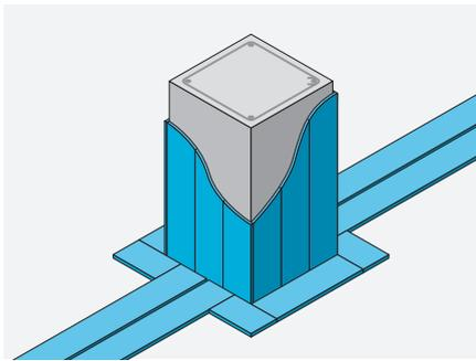
El pilar se cajeará de ladrillo, envolviéndolo previamente con material elástico para evitar las conexiones de la hoja de ladrillo con el pilar. El forrado del pilar llevará bandas en la base y en la cima.
