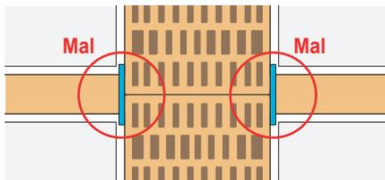
En las paredes separadoras de 1 hoja (Silensis tipo 1) cuando se coloquen bandas en la unión de tabiques u hojas interiores de fachada con la pared, hay que evitar el contacto del yeso de la pared separadora con el yeso de los tabiques y hojas interiores de fachadas.
