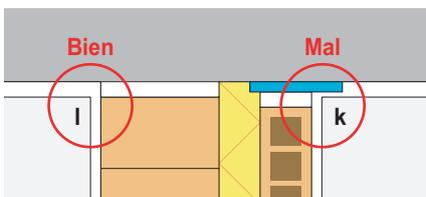
En el caso de banda elástica en 1 sola hoja del cerramiento (Silensis tipo 2B) sólo habrá que desconectar los yesos en esta hoja (k). En la pared sin banda no hay problema por aplicar el yeso continuo entre la pared y el techo (l).
