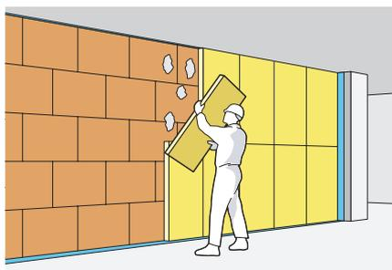
El material absorbente, generalmente lana mineral, se colocará rellenando toda la superficie de la primera hoja de la separadora, sin sufrir roturas durante su colocación y fijándose a la hoja mediante pelladas o fijaciones mecánicas, en función del tipo de lana mineral elegida.
