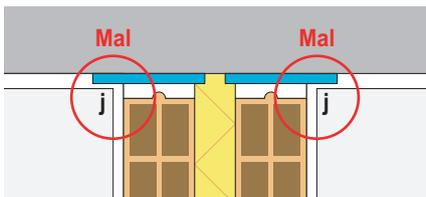
En las hojas con bandas elásticas perimetrales de las paredes dobles (Silensis tipo 2A y 2B) hay que evitar el contacto del yeso de la pared separadora con el yeso del techo (j), para evitar la formación de un puente acústico estructural.
