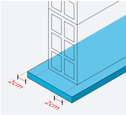
Cada una de las hojas con banda elástica se replanteará al eje de la banda elástica. El ancho de la banda elástica será 4 cm mayor que el espesor del ladrillo. La banda elástica debe sobresalir 2 cm a cada lado de la hoja.
