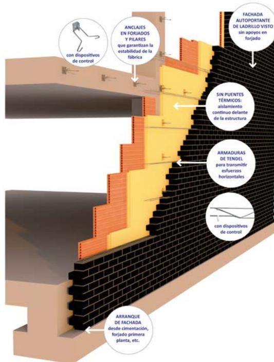
**STRUCTURA®** es la marca registrada por los fabricantes de ladrillo cara vista de **HISPALYT** para denominar a las **fachadas autoportantes de ladrillo cara vista**. En la actualidad el único sistema constructivo reconocido por la marca STRUCTURA es el **sistema G.H.A.S.** (Geo-Hidrol Advanced Systema) desarrollado por la empresa **GEO-HIDROL**.
