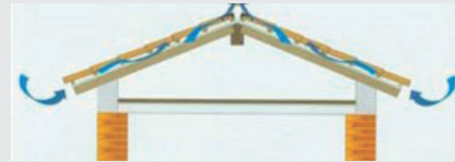
Recorrido ideal del estrato de microventilación
