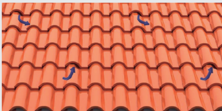
Disposición desencontrada de tejas de entrada y salida de aire
