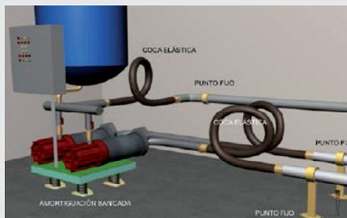
Fig. 5 Ejemplo del tratamiento acústico a llevar a cabo en el grupo de presión
