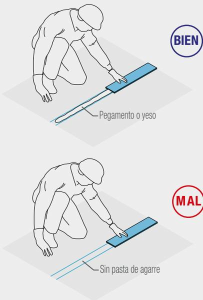
Las bandas elásticas se deben adherir con pegamento escayola o yeso al elemento constructivo en el que se vaya a colocar (forjado inferior, pilares, etc.).
