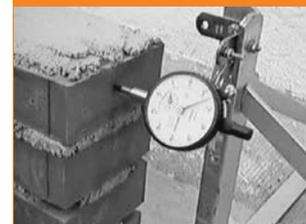
Muretes utilizados en el ensayo. Aspecto del murete de 5 hiladas, punto de medida en el murete de 8 hiladas y detalle de la posición del medidor en el murete de 5 hiladas.
