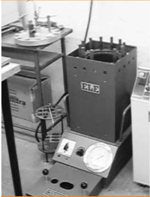
Autoclave empleado para presiones de 1 MPa
