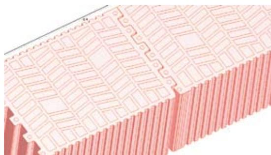
Figura 12. Representación espacial del modelo utilizado para simulación de fábrica de bloque de Termoarcilla
