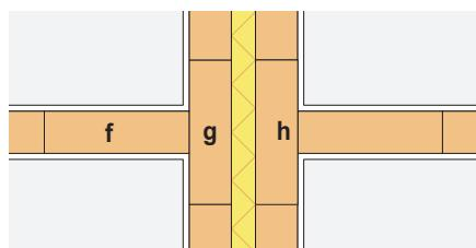
Los tabiques interiores (f) se interrumpen al acometer a la pared separadora (g).
