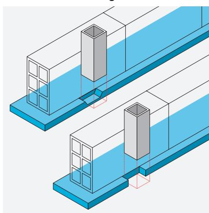
Se realizará aplastando la banda elástica o realizando un mínimo cajeado.
