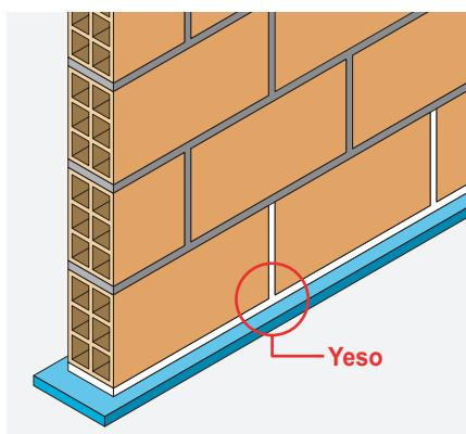
La primera hilada de los tabiques de ladrillo de pequeño formato recibidos con mortero de cemento, se levantará con yeso, pegamento-escayola o cualquier otro material de agarre que garantice una buena adherencia del ladrillo a la banda.
