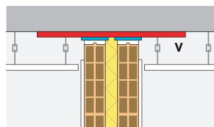
Si el forjado es de bovedillas o casetones debe colocarse un elemento sellante (v) para evitar transmisiones a través del forjado. Si las viguetas son paralelas a la pared separadora, el material sellante se aplicará de vigueta a vigueta. Si son perpendiculares a la pared separadora, el material sellante se aplicará de bovedilla a bovedilla.
