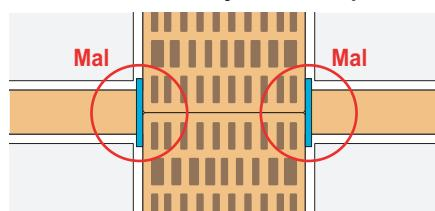
En las paredes separadoras de 1 hoja (Silensis tipo 1) cuando se coloquen bandas en la unión de tabiques u hojas interiores de fachada con la pared, hay que evitar el contacto del yeso de la pared separadora con el yeso de los tabiques y hojas interiores de fachadas.
