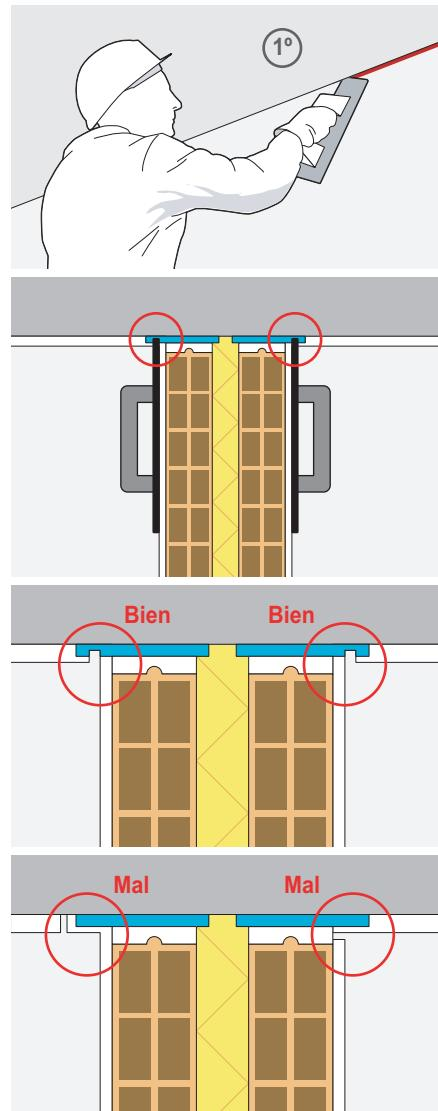
1º Una vez aplicado el yeso a la pared y al techo, pegando la llana contra la pared, cortar verticalmente el yeso hasta alcanzar la banda elástica.
