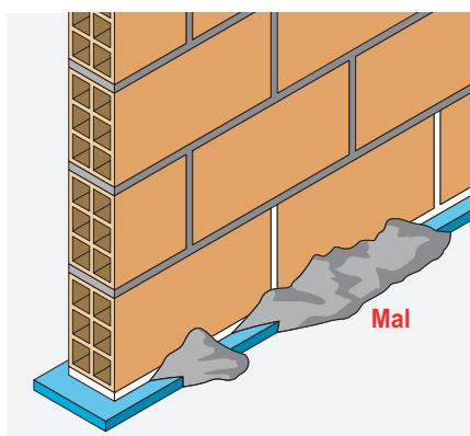
En los tabiques, hojas interiores de fachada y paredes separadoras con bandas en la base, hay que limpiar las rebabas y restos de pasta que hayan caído conectando la banda con el forjado, pues podrían suponer puntos de conexión rígida de la pared con el forjado.
