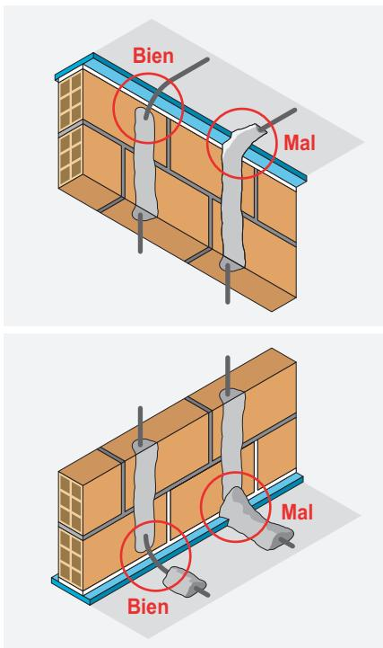
Para evitar transmisiones en las paredes dobles (Silensis tipo 2A ó 2B), se evitara en todo momento la unión rígida de las hojas de la pared separadora que llevan bandas elásticas con los forjados superior e inferior, ocasionada por el macizado de mortero que cubre las instalaciones.
