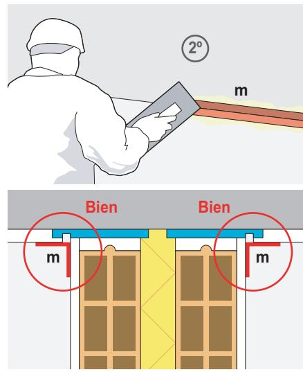
2º) Rematar colocando una tira de papel (m) para tapar la junta, empleando pasta de juntas que no debe penetrar en el corte.
