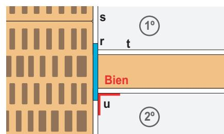
1º) Se deja descubierta la banda elástica (r), aplicando el yeso de la pared contra la banda elástica (s) y el yeso del tabique u hoja interior de la fachada contra la banda elástica (t).
