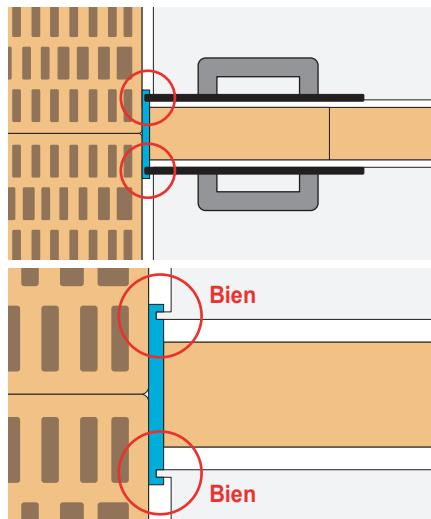
1º) Una vez aplicado el yeso a la pared y al tabique, apoyando la llana en el tabique u hoja interior de fachada, cortar verticalmente el yeso hasta alcanzar la banda elástica.
