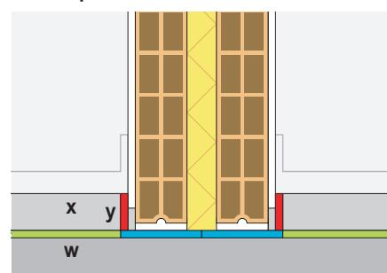
Se evitara dejar discontinuidades en la colocación de la lámina anti-impacto (w) a través de las cuales la niveladora de mortero (x) pueda entrar en contacto con el forjado inferior. Para ello se emplearán bandas perimetrales, cintas de solapes o plásticos (y) siguiendo las recomendaciones del fabricante de la lámina anti-impacto.
