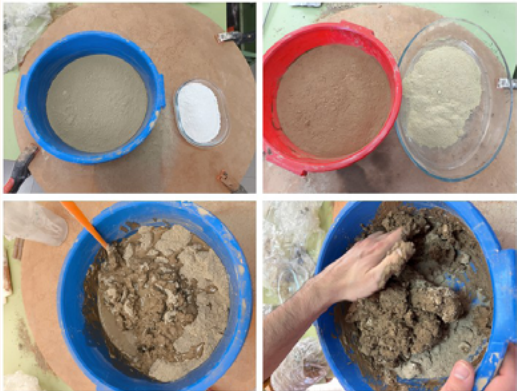
Figura 2. Proceso de mezclado de residuos. Arcilla amarilla y lodos de corte de mármol (columna izquierda) y arcilla roja y polvo de corte de madera (columna derecha).
