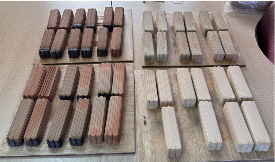
Figura 5. Probetas conformadas mediante fabricación aditiva LDM de diferentes arcillas y residuos en diferentes porcentajes.
