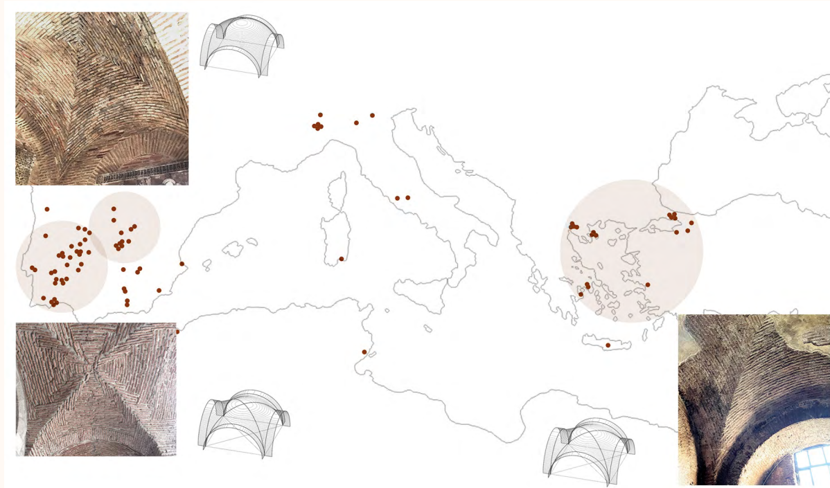
Figura 4. Principales focos de la técnica de bóvedas de ladrillo por hojas sin cimbra en la cuenca mediterránea y tipos predominantes (dibujo de los autores).
