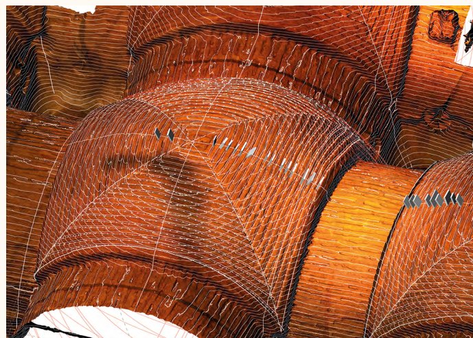
Figura 3. Modelo digital de trabajo, con secciones y líneas de nivel, hiladas, y ladrillos extruidos en la parte superior (dibujo de los autores).
