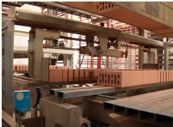
Figura 8. Maquinaria del proceso de fabricación de ladrillos cara vista Fuente: reportaje fabricación de ladrillos cara vista en Fabricando Made in Spain de TVE1.
