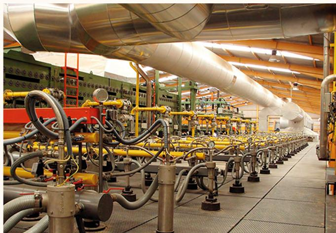
Figura 1. Horno con quemadores de gas natural y recuperadores de calor.
