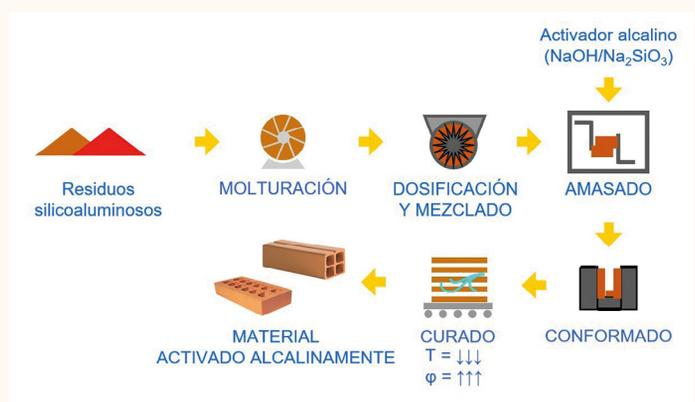
Figura 2. Proceso de fabricación de ladrillos activados alcalinamente.
