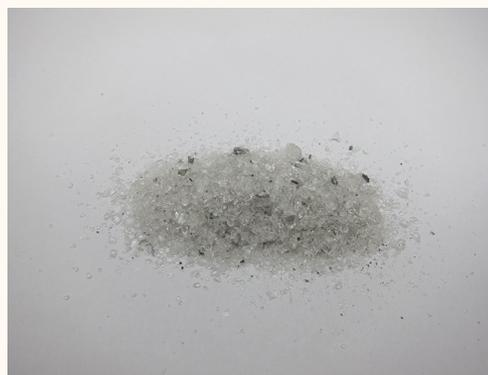
Figura 5. Vidrio de placas solares.
