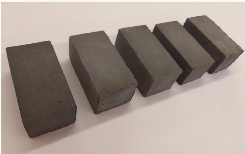
Figura 8. Ladrillos HYPOBRICK obtenidos a escala de laboratorio a partir de un residuo de tiesto cocido cerámico con pigmento negro.
