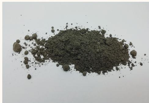
Figura 3. Cenizas volantes de una central termoeléctrica de carbón.
