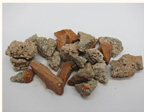
Figura 6. Fracción mineral de RCD.
