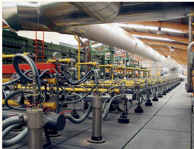
Figura 1. Horno con recuperadores de calor hacia secadero, para la optimización del consumo energético.
