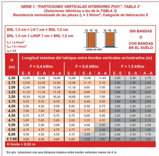
Figura 9. Tabla de ensayos de seguridad de uso sobre una pared cerámica de ladrillo hueco gran formato (LHGF) de 7 cm con un extremo libre y desvinculado en el resto del perímetro por bandas elásticas, realizado según la guía DITE 003 (EOTA) / Edición Diciembre 1998 para elementos de división interior usados como muros no portantes, a la categoría de cargas "a" y uso "III"
