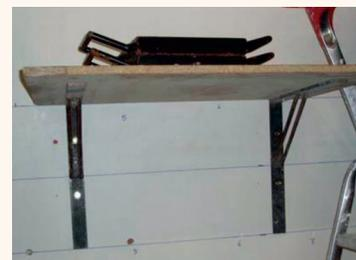
Figura 11. Ensayo de cargas verticales excéntricas sobre una pared cerámica de LHGF de 7 cm, sometido a la pared a la aplicación de forma continuada durante 24 h de una carga de 1000 N a 30 cm de la pared aplicada sobre una estantería
