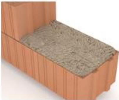
*Montaje 1: Junta horizontal de mortero continua*
