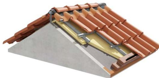
Imágenes: *Structura*, fachadas sin puentes térmicos y nuevas cubiertas ventiladas de teja
