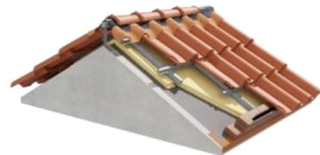
Dicha **microventilación** amortigua los cambios de temperatura y contribuye a la máxima eficiencia energética del edificio. En verano, el aire bajo la teja asciende por convección hacia la salida de aire permitiendo la entrada de aire frío. Esta circulación interior del aire, produce la refrigeración de la cubierta. En invierno, el aire bajo la teja se calienta, pero no lo suficiente como para favorecer la convección, conservando el calor.
