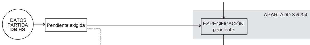
Se deberá comprobar que la pendiente es al menos la mínima indicada para cubiertas planas. En este caso, al tratarse de una cubierta plana no transitable con un acabado de grava, la pendiente debe estar comprendida entre un 1% y un 5%. Además deberán cumplirse las condiciones del capítulo 4. Disposiciones constructivas.
