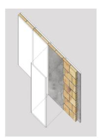
Así, las paredes Silensis-Cerapy son soluciones robustas, de altas prestaciones acústicas, que mantienen las características inherentes a los productos cerámicos, relativas a la resistencia a cargas suspendidas y seguridad frente al intrusismo, inercia térmica, comportamiento frente al fuego, al tiempo que se les suman las ventajas constructivas de la tabiquería seca de las placas de yeso, mejorándose los rendimientos y los acabados finales en obra.
