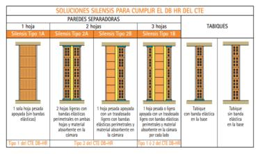
Avanzando en la industrialización de la tabiquería cerámica, Hispalyt presenta las **paredes** Silensis-Cerapy, que consisten en aplicar revestimientos de placa de yeso a las paredes de ladrillo.
