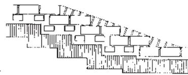
Figura 100. Escaleras de capas rodantes con adoquines cerámicos colocados a tizón.
