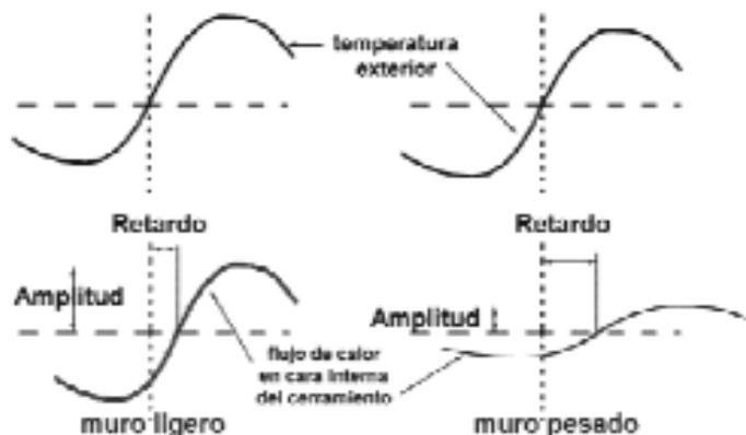
Fig. 6 - Efectos de la señal interior según la inercia del cerramiento
