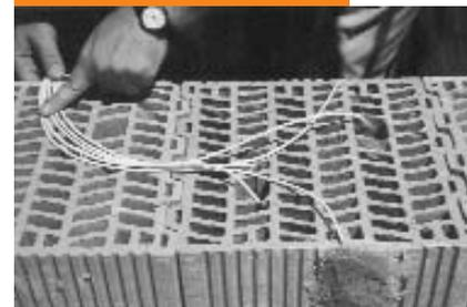
Fig. 9. Detalle de la colocación de las sondas de temperatura en las diferentes capas de registro.
