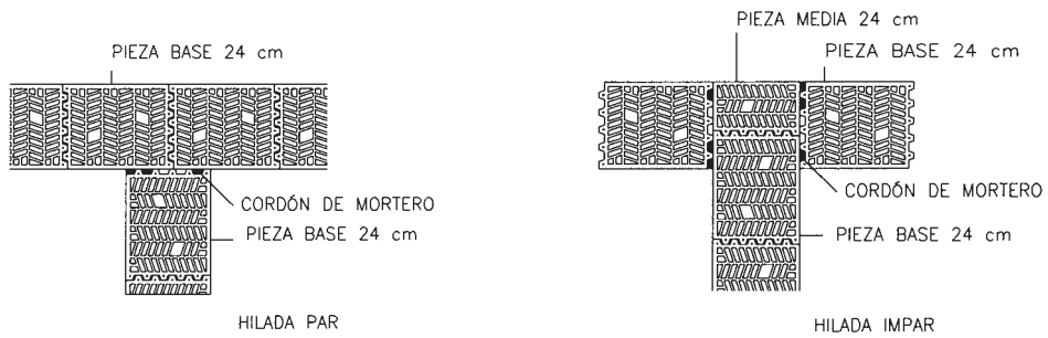
Detalle de encuentro en T de muros de 24 cm
