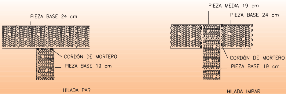
Detalle de encuentro en T de muro de 19 cm con muro de 24 cm
