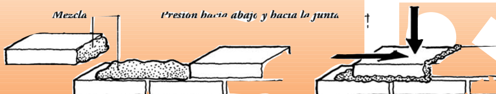
Colocación a restregón de ladrillos
